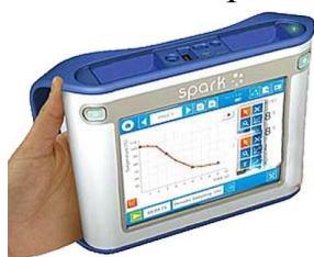
Рис. 7. Мобільний пристрій SPARK, ЦЛ «Pasco»
