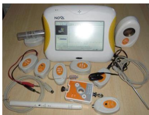
Рис. 11. КПК «NOVA 5000» і датчики
