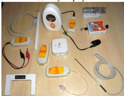
Рис. 10. NOVA Link і комплект датчиків
