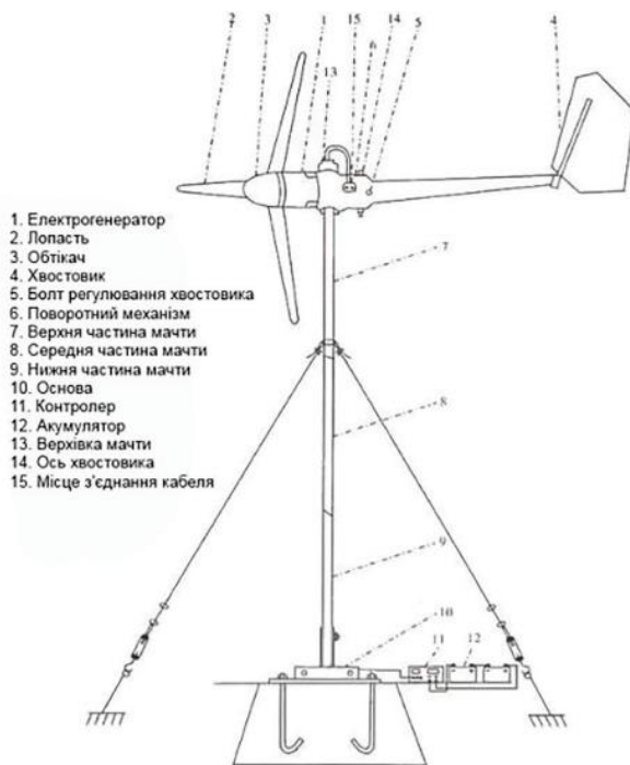
Рис. 2.4. Схема вітрогенератора
