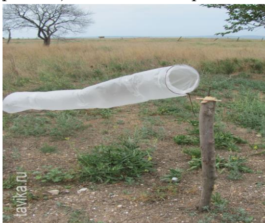
Рис. 17. Саморобний вітровий конус на тимчасовому метеопості
