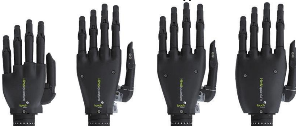
Рис. 7.11. i-Limb Quantum (Touch Bionics) (до 36 типів захоплення; інтегрований Bluetooth і додаток для програмування; сенсорний контроль через скорочення м'язів і акселерометр)
