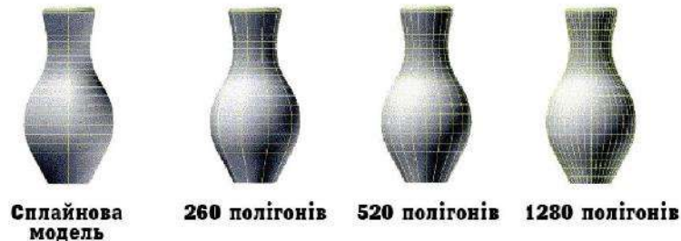
Рис. 1.21. Порівняння сплайнової і полігональної моделі
