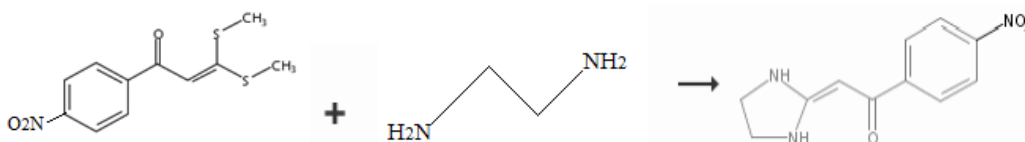
Рис. 3. Схема синтезу 2-(імідазолідин-2)-нітроацетофенону.
