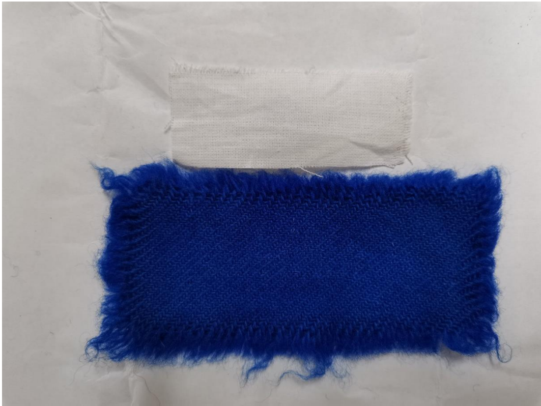
Рисунок 3.10. Фарбування з «Кололевелом»
