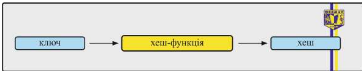
Рис.1.1.4. Принцип роботи хеш-функції
