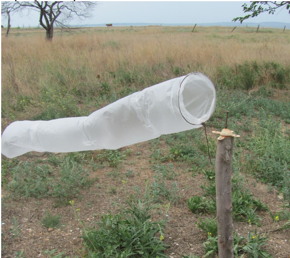
Рис. 17. Саморобний вітровий конус на тимчасовому метеопості
