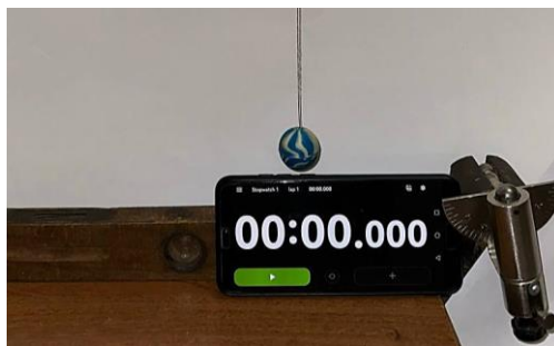
Рис. 5. Вигляд експериментальної установки на базі пружинної гармати.
