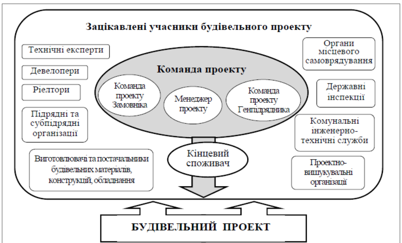
Рис. 1.5. Взаємозв'язки між зацікавленими учасниками будівельного проєкту (Фесенко Т. Г., Мінаєвим Д. М., Антипенко К. В.) [36, с. 108].
