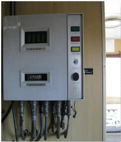
Рис. 3. Центральний прилад індукційного лага
